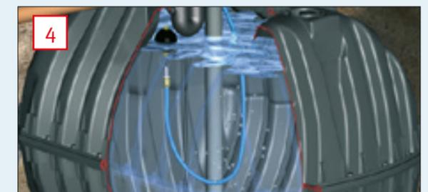
取水口由浮球牵引，位于水面之下，雨水经位于水下的取水口流出，避免了水面上的浮尘一同流出。
